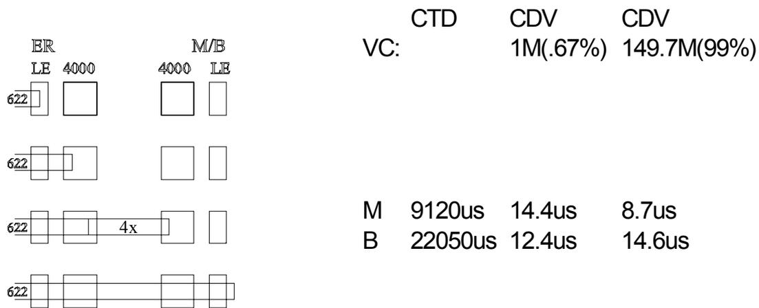
Abb. 4 Delay (CTD) / Jitter (CDV) -Messungen auf einer künstlich verlängerten Strecke.
